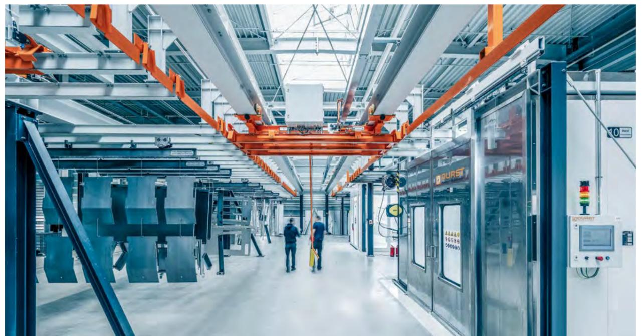
Links des Querbörderers liegt der Bahnhof, rechts befindet sich die Anlagentechnik mit Waschkabine, Haftwassertrockner, Pulverkabine und Einbrennofen.
