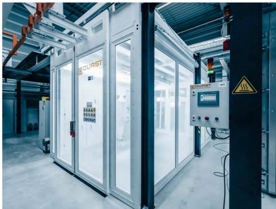
Die Pulverkabine ist an zwei Seiten verglast und mit einer blendfreien LED-Beleuchtung ausgestattet.
