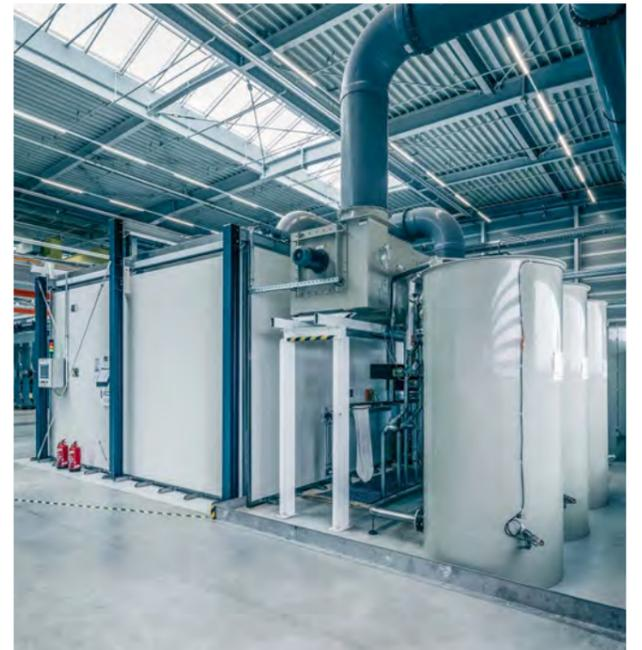
Hinter den Kabinen und den Öfen sind die Tanks für die Vor- und Abwasserbehandlung. Fotos: Durst Pulverbeschichtungsanlagen
