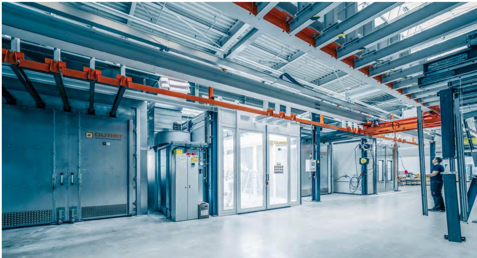
Der Haftwassertrockner und der Einbrennofen (links) stehen etwas zurückgesetzt. Sie sind baugleich und werden aktuell mit Strom beheizt. Ein Brennermodul für Gas kann nachgerüstet werden.
