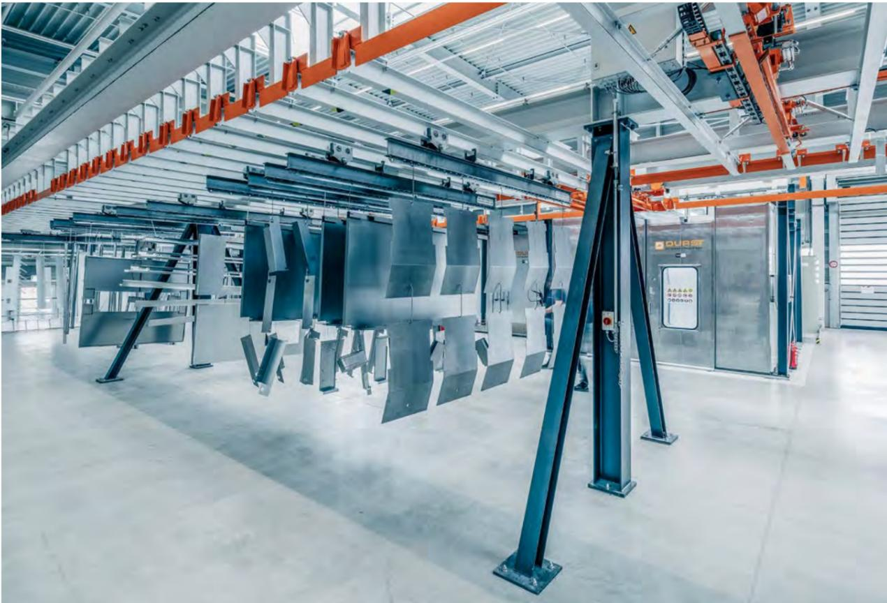
Der linke Querbörderer ist mit einer Hub- und Senkstation ausgestattet, so dass die beschichteten Werkstücke ohne Störung des Lackierprozesses an die firmeninterne Logistik übergeben werden können.
